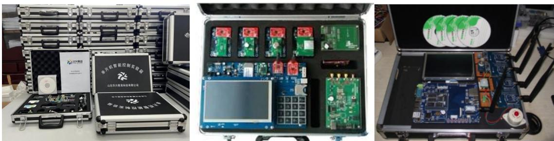
企业方还在长清大学科技园实训基地投资10余万元建立了智能家居实验室，它是一个由硬件设备、软件平台和教学资源库三部分组成完整的教学实验体系，由实验平台、实验模块、实验软件、物联网云平台、实验开发工具等模块组成。可完成单片机技术、传感器技术、数据采集、无线传感网络、智能终端开发、电路设计等课程的实验安排。
